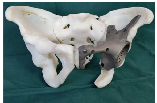
图 3 术前骨盆三维模型及钛合金金属假体
